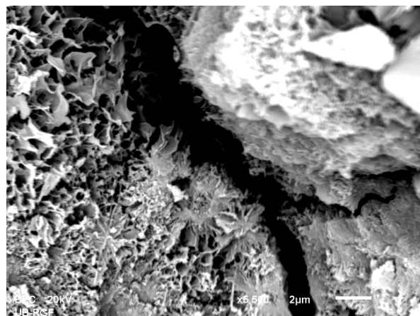
Slika 5. SEM slika - Uzorci izloženi 5% rastvoru mlečne kiseline Figure 5. SEM image - Specimens exposed to 5% lactic acid solution
