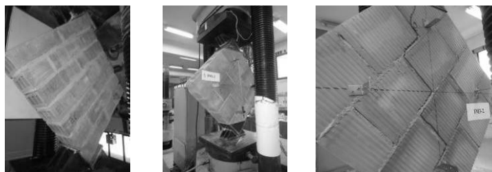
Slika 5. Ispitivanje zidova na smicanje usljed dijagonalnog zatezanja Figure 5. Walls tested on the shear due to diagonal tension failure
