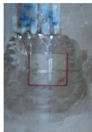
Slika 10. Cilindrični uzorak za konvencionalni triaksijalni test; a) dispozicija mjernih rozeta; b) rozeta postavljena na uzorak Figure 10. Cylindrical specimen for a conventional tree-axial test; a) disposition of measurement rosetta; b) rosettes attached to the specimen
